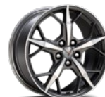
Aluminiumfelgen mit 5-Dreizack-Speichen, geschliffenen Stirnflächen und Spectra Gray Finish: vorn 19 X 8,5 J und hinten 20 X 11,0 J (Q8T)
