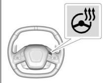
: Drücken Sie auf diese Taste (ausstattungsabhängig), um die Lenkradheizung einoder auszuschalten. Eine Anzeige neben der Taste leuchtet, wenn die Funktion eingeschaltet ist.
