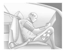
Beim Fahren in einem Fahrzeug bewegen Sie sich ebenso schnell wie das Fahrzeug. Wird das Fahrzeug plötzlich gestoppt, dann bewegen Sie sich weiter, bis Sie etwas stoppt. Das können die Windschutzscheibe, das Armaturenbrett oder die Sicherheitsgurte sein!
