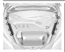
Die vier Clips der linken und rechten äußeren Abdeckungen lösen.
