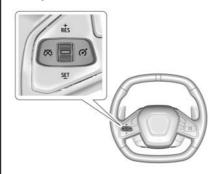
ኛ3 : Drücken, um den Geschwindigkeitsregler ein- bzw. auszuschalten. Bei Aktivierung des Geschwindigkeitsreglers leuchtet eine weiße Anzeigeleuchte im Instrument auf.
