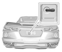
Das Kennzeichenschild entfernen, um auf den zweiten Reserve-Türschlosszylinder an der Heckklappe zuzugreifen.
