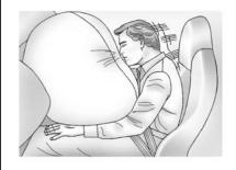
Der Front-Airbag des Beifahrers befindet sich auf der Beifahrerseite in der Instrumententafel.
