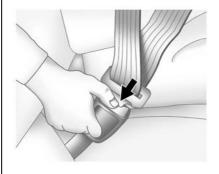
Zum Entriegeln des Gurtes drücken Sie den Knopf am Schloss. Der Gurt sollte in seine Ausgangsposition zurückkehren.
