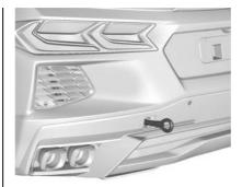
Die Abschleppöse an den Anschluss installieren und so lange drehen, bis sie vollständig festgezogen ist.
