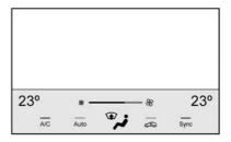
Der Status der Klimatisierung wird kurz angezeigt, wenn die Klimatisierungseinstellungen an der Mittelkonsole angepasst werden.
