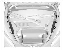
Die vier Clips für die linken und rechten äußeren Abdeckungen lösen.
