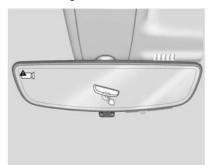
Wenn ein blaues Display und Im Spiegel angezeigt werden und das Display ausgeschaltet wird, das Fahrzeug zur Wartung zum Händler bringen. Außerdem den Hebel wie angegeben drücken, um in den Modus mit automatisch abblendendem Rückspiegel zurückzukehren.
