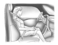
Wenn sich eine erwachsene Person auf dem Beifahrersitz befindet und die Anzeige "OFF" (AUS) leuchtet, kann dies daran liegen, dass die betreffende Person nicht korrekt auf dem Sitz sitzt oder dass die Kindersitz-Sperrfunktion aktiviert ist. Gehen Sie wie folgt vor, um dem System die Erkennung der betreffenden Person und die Aktivierung des Beifahrer-Front-Airbags zu ermöglichen:
