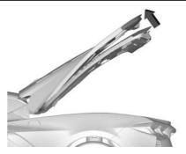
Um besseren Zugang auf den Motor- oder Kofferraumbereich zu erhalten, kann die Heckklappe manuell in eine noch weiter geöffnete Position gedrückt werden. Keine übermäßige Kraft anwenden.
