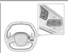
der > : Drücken, um nach links oder rechts durch die interaktiven Displaybereiche des Instruments zu springen. Zum Auswählen auf das Daumenrädchen drücken.
