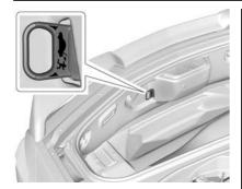
Innen im Laderaum befindet sich an der Rückwand ein Notentriegelungsgriff, der im Dunkeln leuchtet. Der Griff beginnt zu leuchten, nachdem er angestrahlt wurde. Am Entriegelungsgriff ziehen, um die Heckklappe von innen zu öffnen.
