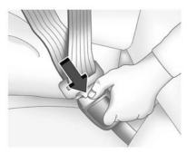
Zum Entriegeln des Gurtes drücken Sie den Knopf am Schloss. Der Gurt sollte in seine Ausgangsposition zurückkehren.
