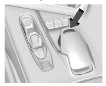
Zum Aktivieren von "Mein Modus" oder des Wetter-, Tour-, Sport- oder Rennmodus den Regler der Fahrermodussteuerung (DMC, Driver Mode Control) an der Mittelkonsole drehen, um einen Modus auszuwählen. Wenn ein Modus ausgewählt wird, leuchtet im Kombiinstrument eine entsprechende Anzeige dauerhaft auf.
