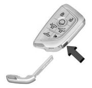
Die Taste an der Seite des Funkschlüssels drücken und den mechanischen Schlüssel herausziehen. Den mechanischen Schlüssel niemals herausziehen, ohne die Taste zu drücken.
