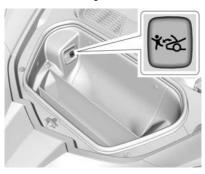
Im Motorraum befindet sich eine Notfreigabetaste, die im Dunkeln glimmt. Die Taste beginnt zu glimmen, nachdem sie Licht ausgesetzt wurde. Die Taste drücken, um die Motorhaube vom Motorraum aus zu öffnen.
