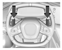
Bei Getriebe in Stellung "D" (Drive) den Schalter "M" (Manual Mode) an der Mittelkonsole drücken, um in den Manuell-Modus zu wechseln. Mit den Schaltwippen am Lenkrad manuell hoch- oder herunterschalten. Die rechte Plus-Schaltwippe (+) dient zum Hochschalten, die linke Minus-Schaltwippe (–) zum Herunterschalten.
