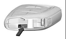
Das Schlüsselblatt des mechanischen Schlüssels in den Schlitz einführen, um die Batterieabdeckung zu entfernen.
