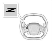
Zum Aktivieren des Z-Modus die Z-Modus-Taste am Lenkrad drücken. Zum Deaktivieren entweder einen anderen Modus über den DMC-Regler auswählen oder die Z-Modus-Taste am Lenkrad drücken. Wenn der Z-Modus über die Z-Modus-Taste deaktiviert wird, wird die Fahrermodussteuerung immer auf den Tourmodus zurückgesetzt.
