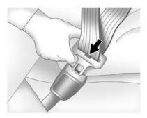
Drücken Sie die Schlosszunge in das Gurtschloss, bis sie hörbar eingerastet ist. Ziehen Sie anschließend an der Schlosszunge, um sicherzugehen, dass sie fest sitzt.
