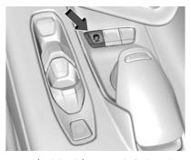
Die TCS/StabiliTrak/ECS-Taste befindet sich in der Mittelkonsole.
