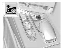
Zur Verwendung des Frontliftsystems die Taste an der Mittelkonsole drücken, um das Fahrzeug anzuheben oder zu senken. Die Funktion kann bei Geschwindigkeiten bis 38 km/h (24 mph) bei laufendem Motor verwendet werden. Das System arbeitet je nach Fahrzeugstatus oder Betriebsmodus:
