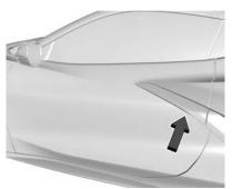
Zum schlüssellosen Zugang den Funkschlüssel in eine Entfernung von höchstens 1 m (3 ft) zum Türgriff bringen. Das Touchpad am Türgriff greifen und drücken. Siehe Bedienung des schlüssellosen Zugangssystems (RKE-System)
