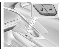
Die Türen können auch mit der Zentralverriegelungstaste an der Beifahrertür ver- und entriegelt werden.
