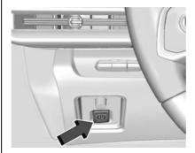
Die elektrische Parkbremse (EPB) kann jederzeit betätigt werden, auch bei ausgeschaltetem Fahrzeug. Bei zu geringer Batterieleistung kann die EPB weder betätigt noch gelöst werden. Um ein Entleeren der Batterie zu verhindern, unnötige wiederholte Zyklen der EPB vermeiden.
