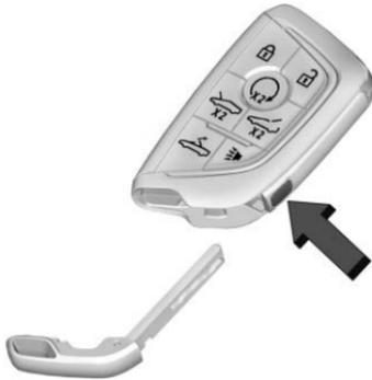
1. Die Taste an der Seite des Funkschlüssels drücken und den mechanischen Schlüssel herausziehen. Den mechanischen Schlüssel niemals herausziehen, ohne die Taste zu drücken.
