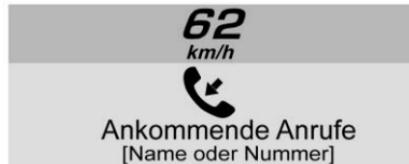
**Mobiltelefon** : Kann angezeigt werden, wenn auf einem per Bluetooth verbundenen Mobiltelefon ein Anruf eingeht. Wird kurzzeitig eingeblendet, bis der Anruf angenommen bzw. ignoriert wird.
