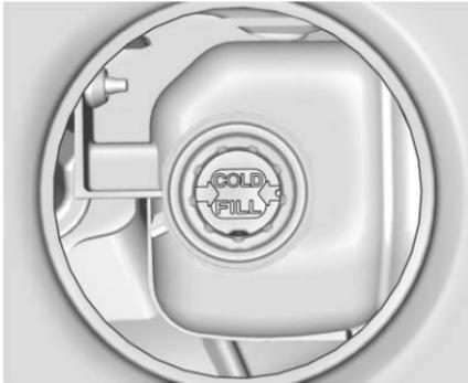
4. So viel Mischung im richtigen Mischverhältnis in den Kühlmittelausgleichbehälter einfüllen, bis sich der Stand an der Füllmarkierung „COLD FILL“ (KALT EINFÜLLEN) am Behälter stabilisiert.
