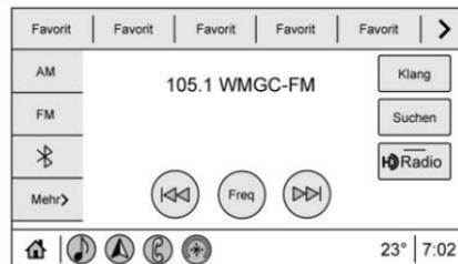
Bei ausgewählter AM- oder FM-Quelle ⏪ oder ⏩ an den Konsolenbedienelementen drücken, um einen Suchlauf vorwärts oder rückwärts zum nächsten Sender mit starkem Empfang auszuführen.
