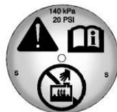
2. Den Druckdeckel entfernen, wenn sowohl das Kühlsystem als auch der Druckdeckel am Kühlmittelausgleichbehälter und der Motor nicht mehr heiß sind.
