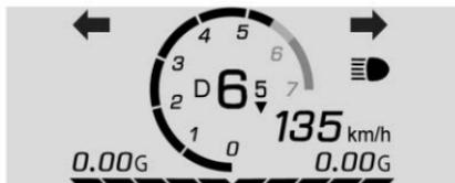
**Sport** : Zeigt die Fahrzeuggeschwindigkeit, einen kreisförmigen Drehzahlmesser, die Gangposition, die Schaltanzeige und den G-Kraft-Messer an.
