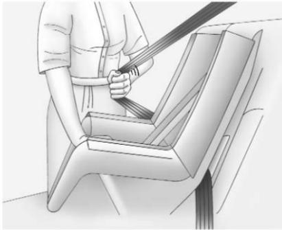
6. Ziehen Sie den Schultergurt ganz aus dem Gurtaufroller heraus, um die Blockierung einzustellen. Wenn die Blockierung des Gurtaufrollers eingestellt ist, kann der Gurt gestrafft werden aber nicht aus dem Gurtaufroller gezogen werden.
