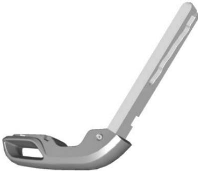
Der mechanische Schlüssel kann zum Öffnen des Fahrzeugs verwendet werden, wenn die Stromversorgung des Fahrzeugs unterbrochen ist.
