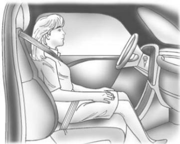
Wenn sich eine erwachsene Person auf dem Beifahrersitz befindet und die Anzeige „OFF“ (AUS) leuchtet, kann dies daran liegen, dass die betreffende Person nicht korrekt auf dem Sitz sitzt oder dass die Kindersitz-Sperrfunktion aktiviert ist. Gehen Sie wie folgt vor, um dem System die Erkennung der betreffenden Person und die Aktivierung des Beifahrer-Front-Airbags zu ermöglichen:
