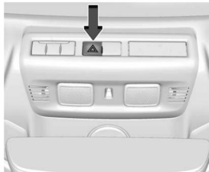
Der Warnblinker zeigt an, dass Sie in Schwierigkeiten sind. Die Taste befindet sich an der Dachkonsole.
