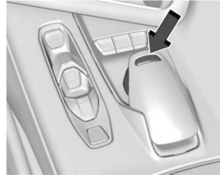
Zum Aktivieren von „Mein Modus“ oder des Wetter-, Tour-, Sport- oder Rennmodus den Regler der Fahrermodussteuerung (DMC, Driver Mode Control) an der Mittelkonsole drehen, um einen Modus auszuwählen. Wenn ein Modus ausgewählt wird, leuchtet im Kombiinstrument eine entsprechende Anzeige dauerhaft auf.
