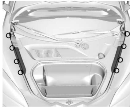
1. Die vier Clips für die linken und rechten äußeren Abdeckungen lösen.
