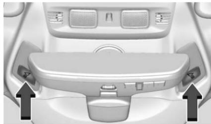
Falls vorhanden, befinden sich die Leseleuchten befinden sich in der Dachkonsole. Die Leuchten leuchten auf, wenn eine beliebige Tür geöffnet, am Funkschlüssel auf
