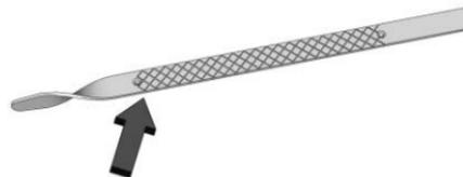
Wenn der Ölstand unter dem kreuzschraffierten Bereich der Messstabspitze liegt, durch die Einfüllöffnung am Öltankeinfüllstutzen einen Liter (1 qt) des empfohlenen Öls nachfüllen und den Ölstand erneut kontrollieren. Informationen zum richtigen Öltyp sind unter „Das richtige Motoröl wählen“ weiter unten in diesem Abschnitt verfügbar. Motoröl-Füllmenge im Kurbelgehäuse siehe *Füllmengen und Spezifikationen* ⇨ 354.
