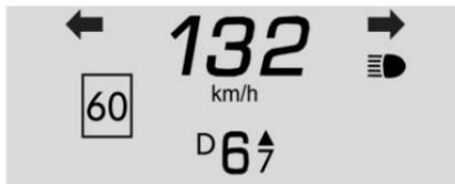
**Touring** : Zeigt die Fahrzeuggeschwindigkeit, Gangposition, Schaltanzeige und das Geschwindigkeitsschild an.
