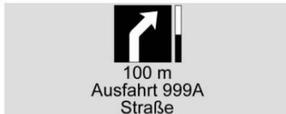
**Navigation** : Turn-by-Turn-Anweisungen können angezeigt werden, wenn die Navigation aktiv ist und ein Fahrmanöver kurz bevorsteht. Sie werden bis zum Abschluss des Fahrmanövers angezeigt. Danach kehrt das Head-up-Display zur vorigen Anzeige zurück.
