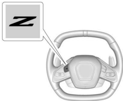
Zum Aktivieren des Z-Modus die Z-Modus-Taste am Lenkrad drücken. Zum Deaktivieren entweder einen anderen Modus über den DMC-Regler auswählen oder die Z-Modus-Taste am Lenkrad drücken.
