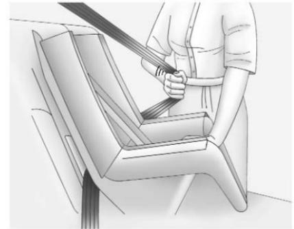
6. Ziehen Sie den Schultergurt ganz aus dem Gurtaufroller heraus, um die Blockierung einzustellen. Wenn die Blockierung des Gurtaufrollers eingestellt ist, kann der Gurt gestrafft werden aber nicht aus dem Gurtaufroller gezogen werden.
