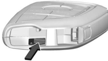
2. Das Schlüsselblatt des mechanischen Schlüssels in den Schlitz einführen, um die Batterieabdeckung zu entfernen.
