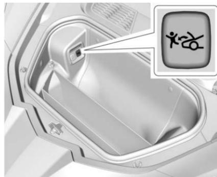
Im Motorraum befindet sich eine Notfreigabetaste, die im Dunkeln glimmt. Die Taste beginnt zu glimmen, nachdem sie Licht ausgesetzt wurde. Die Taste drücken, um die Motorhaube vom Motorraum aus zu öffnen.
