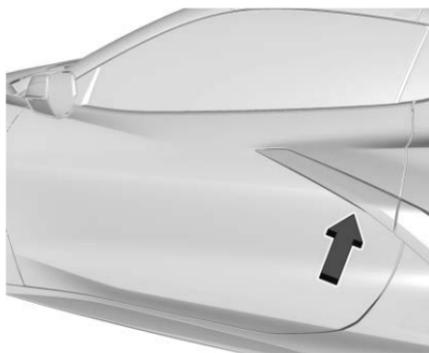
Zum schlüssellosen Zugang den Funkschlüssel in eine Entfernung von höchstens 1 m (3 ft) zum Türgriff bringen. Das Touchpad am Türgriff greifen und drücken. Siehe *Funkschlüsselbedienung* ⇨ 10. Diese Funktion kann programmiert werden. Um die verfügbaren Einstellungen auf dem Infotainment-Bildschirm anzuzeigen, berühren Sie *Settings > Vehicle > Remote Lock, Unlock, Start* (Einstellungen > Fahrzeug > Fernverriegelung, Entriegelung, Start).
