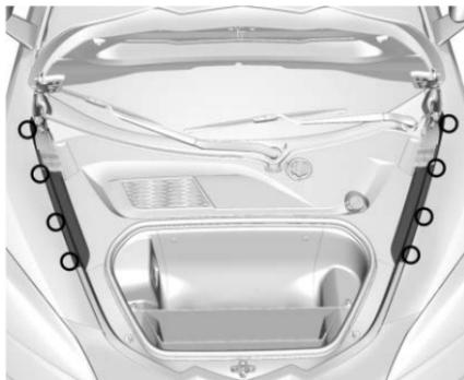
5. Die vier Clips der linken und rechten äußeren Abdeckungen lösen.
