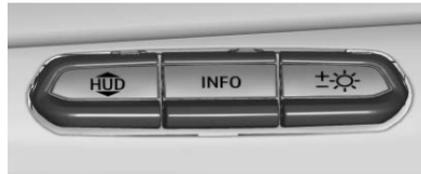
Das HUD-Bedienelement befindet sich bei Fahrzeugen mit Linkslenkung links neben dem Lenkrad an der Instrumententafel und bei Fahrzeugen mit Rechtslenkung rechts neben dem Lenkrad an der Instrumententafel.
