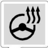
: Drücken Sie auf diese Taste (ausstattungsabhängig), um die Lenkradheizung ein- oder auszuschalten. Eine Anzeige neben der Taste leuchtet, wenn die Funktion eingeschaltet ist.
