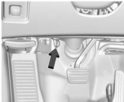
1. Die Schlaufe des manuellen Entriegelungskabels links neben dem Bremspedal suchen.
