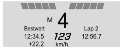
**Rennen** : Zeigt die Fahrzeuggeschwindigkeit, die Gangposition, die Schaltleuchten und die aktuelle und beste Rundenzeit an. Außerdem wird der Gewinn/Verlust auf der aktuellen Runde im Vergleich zur besten Runde angezeigt.
