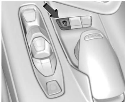
Die TCS/StabiliTrak/ECS-Taste befindet sich in der Mittelkonsole.
