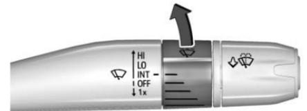
**INT** : Für Wischintervalle bringen Sie den Hebel in die Position INT und drehen Sie dann den Ring
