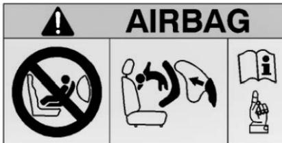
Rückwärtsgerichtete Kinderrückhaltesysteme dürfen nicht in das Fahrzeug eingebaut werden, selbst wenn der Airbag ausgeschaltet ist.
