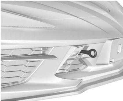
Die Abschleppöse an den Anschluss installieren und so lange drehen, bis sie vollständig festgezogen ist.
