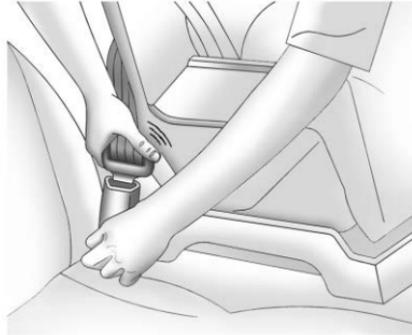
5. Drücken Sie die Schlosszunge in das Gurtschloss, bis sie hörbar eingerastet ist. Den Entriegelungsknopf am Schloss vom Kinderrückhaltesystem weg positionieren, damit der Sicherheitsgurt bei Notwendigkeit rasch geöffnet werden kann.
