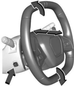
Drücken Sie auf das Bedienelement, um das elektrisch verstellbare Lenkrad nach oben und unten bzw. nach vorne und hinten zu bewegen.
