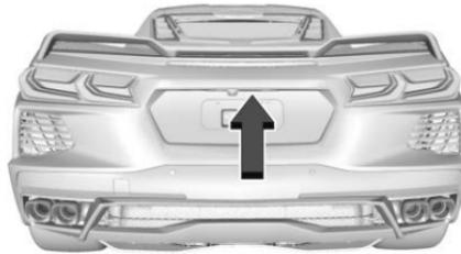
Das Entriegelungs-Touchpad an der Heckklappe drücken, um die Heckklappe zu öffnen, während sich der Funkschlüssel in einer Entfernung bis zu 1 m (3 ft) befindet.
