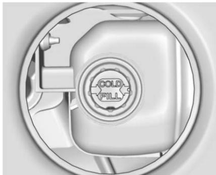
Bei kaltem Motor sollte der Kühlmittelstand im Kühlmittelausgleichbehälter bei der Füllmarkierung „COLD FILL“ (KALT EINFÜLLEN) liegen.
