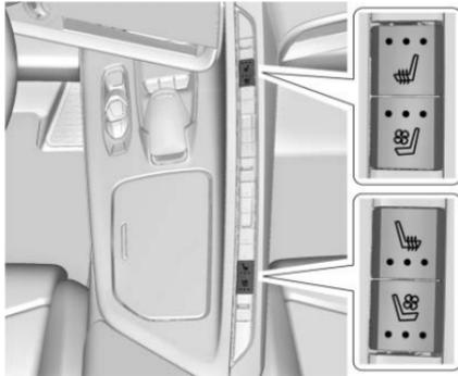
Falls vorhanden, befinden sich die Tasten in der Nähe der Klimaregler an der Konsole. Zum Betrieb muss der Motor laufen.
