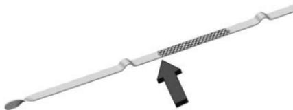
Wenn der Ölstand unter dem kreuzschraffierten Bereich der Messstabspitze liegt, durch die Einfüllöffnung am Öltankeinfüllstutzen einen Liter (1 qt) des empfohlenen Öls nachfüllen und den Ölstand erneut kontrollieren. Informationen zum richtigen Öltyp sind unter „Das richtige Motoröl wählen“ weiter unten in diesem Abschnitt verfügbar. Motoröl-Füllmenge im Kurbelgehäuse siehe *Füllmengen und Spezifikationen* ⇨ 354.
