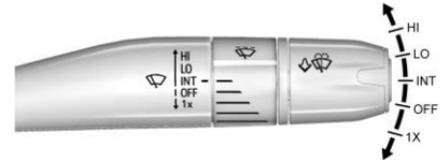
Der Hebel der Wisch-/Waschanlage befindet sich an der rechten Seite der Lenksäule.
