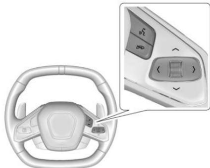
**< oder >** : Drücken, um nach links oder rechts durch die interaktiven Displaybereiche des Instruments zu springen. Zum Auswählen auf das Daumenrädchen drücken.
