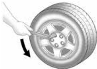
3. Lockern Sie alle Radmutter mit dem voll ausgezogenen Radmutter Schlüssel um eine halbe Drehung gegen den Uhrzeigersinn. Entfernen Sie die Radmutter noch nicht.
