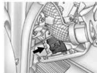
Der Sicherungskasten der Instrumententafel befindet sich seitlich auf der Fahrerseite der Instrumententafel. Um auf die Sicherungen zugreifen zu können, ziehen Sie die Sicherungskastenklappe nach außen und öffnen Sie sie.
