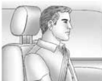
Wenn das Fahrzeug mit einfachen Sitzen ausgestattet ist, stellen Sie die Kopfstütze so ein, dass sich deren Oberkante auf gleicher Höhe mit der Oberseite des Kopfes des Insassen befindet. In dieser Position wird die Wahrscheinlichkeit einer Nackenverletzung bei einem Unfall verringert.
