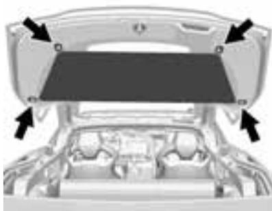
Hängen Sie die elastischen Schlaufen, die sich an den vier Ecken der Gepäckabdeckung befinden, in die Haken an den vorderen und hinteren Ecken des Kofferraumdeckels ein.
