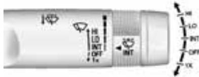
Während sich die Zündung in der Stellung ACC/ACCESSORY (Zubehör) oder ON/RUN/START (Ein/Betrieb/Start) befindet, bewegen Sie den Scheibenwischerhebel, um die Wischgeschwindigkeit auszuwählen.
