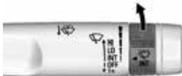
**INT:** Für Wischintervalle bringen Sie den Hebel in die Position INT und drehen Sie dann den Ring INT nach oben für häufigeres Wischen bzw. nach unten für weniger häufiges Wischen.
