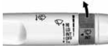
**INT (Intervallwischen):** Für Wischintervalle bringen Sie den Hebel in die Position INT und drehen Sie dann den Ring
