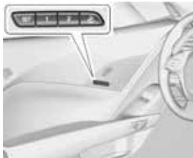
Sofern vorhanden, werden mit den Tasten „1“, „2“, SET und
