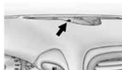
Achten Sie darauf, dass der Lichtsensor oberhalb der Instrumententafel nicht abgedeckt ist.
