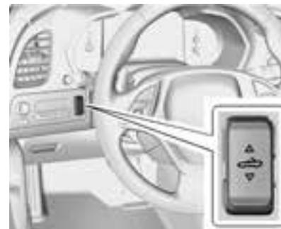
5. Drücken Sie lange auf den oberen Teil von
