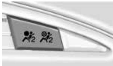
Die Symbole für EIN und AUS sind während der Systemprüfung zu sehen. Nach Abschluss der Systemprüfung, ist entweder das Symbol EIN oder das Symbol AUS zu sehen. Siehe *Beifahrer-Airbag-Statusanzeige auf Seite 5-16*.
