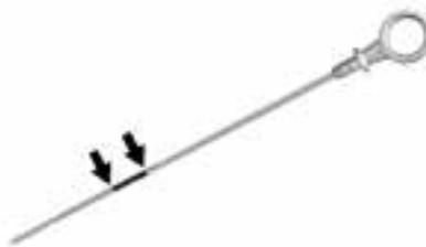
Wenn der Ölstand unter dem kreuzschraffierten Bereich der Messstabspitze liegt, füllen Sie durch die Einfüllöffnung am Öltank einen Liter (1 qt) des empfohlenen Öls nach und überprüfen Sie den Ölstand erneut. Unter "Das richtige Motoröl wählen" finden Sie weitere Erklärungen dazu, welches Öl zu verwenden ist. Motoröl-Füllmenge im Kurbelgehäuse siehe *Füllmengen auf Seite 12-2*.
