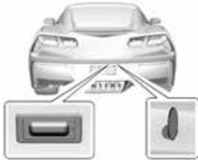
Drücken Sie auf das Tastfeld zur Kofferraumentriegelung, wenn sich der RKE-Transmitter in Reichweite befindet, oder verwenden Sie den Schlüssel im Schließzylinder. Siehe *Schlüssel auf Seite 2-1*.
