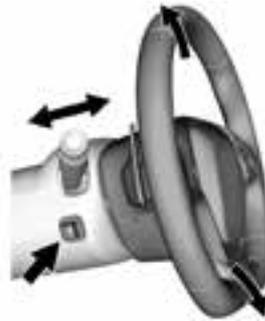
Drücken Sie auf das Bedienelement, um das elektrisch verstellbare Lenkrad nach oben und unten bzw. nach vorne und hinten zu bewegen.
