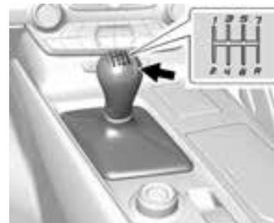
Hier das Schaltschema des 7-Gang-Schaltgetriebes.
