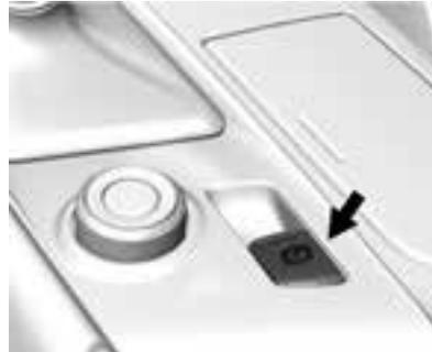
Das Fahrzeug hat eine elektrische Parkbremse (EPB). Der Schalter befindet sich in der Mittelkonsole. Die elektrische Feststellbremse lässt sich zu jeder Zeit aktivieren, auch bei ausgeschalteter Zündung.
