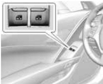
Ziehen Sie den Schalter nach oben, um das Fenster zu schließen, bzw. drücken Sie darauf, um es zu öffnen. Siehe *Elektrische Fensterbetätigung auf Seite 2-21*.
