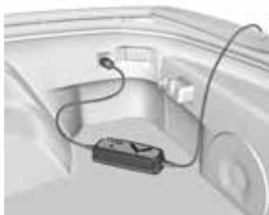
Einige Fahrzeuge verfügen über ein Erhaltungsladerpaket. Befolgen Sie die Anweisungen zum Erhaltungsladerpaket, um den Ladezustand der Batterie beim nicht genutzten Fahrzeug aufrechtzuerhalten. Stecken Sie den Erhaltungslader nur an die hintere Zubehörsteckdose an. Die vordere Zubehörsteckdose wird nach dem Ausschalten der Zündung deaktiviert.
