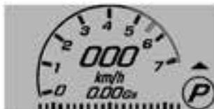
**Sport:** Umfasst die Fahrgeschwindigkeit, einen runden Drehzahlmesser, eine Schaltanzeige und den g-Kraft-Messer.
