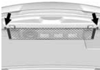
Unter Umständen verfügt das Fahrzeug über ein Gepäcknetz für kleinere Gegenstände. Befestigen Sie das Netz an den Haken hinten im Kofferraum. Das Netz sollte nicht zur Aufbewahrung von schweren Lasten benutzt werden.
