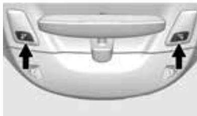
Die Leseleuchten befinden sich in der Dachkonsole. Diese Leuchten werden beim Öffnen einer Tür eingeschaltet. Drücken Sie bei geschlossenen Türen auf die betreffenden Schalter, um die Leuchten einzeln einzuschalten.
