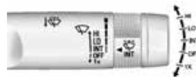
Bewegen Sie den Hebel, während sich die Zündung in der Stellung ACC/ACCESSORY oder ON/RUN/START befindet, um die gewünschte Wischgeschwindigkeit auszuwählen.
