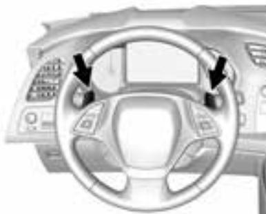
Die Gangwechselerkennung („Active Rev Matching“; ARM) passt die Motordrehzahl jeweils an den nächsten ausgewählten Gang an und sorgt so für fließendere Schaltvorgänge. Das System lässt sich durch Drücken eines der mit REV MATCH gekennzeichneten Tippschalter am Lenkrad ein- und ausschalten. Siehe *Gangwechselerkennung (ARM) auf Seite 9-26*.
