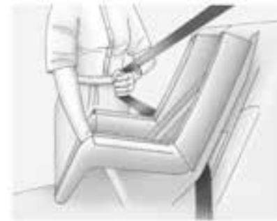
5. Ziehen Sie den Schultergurt ganz aus dem Gurtaufroller heraus, um die Blockierung einzustellen. Wenn die Blockierung des Gurtaufrollers eingestellt ist, kann der Gurt gestrafft werden aber nicht aus dem Gurtaufroller gezogen werden.
