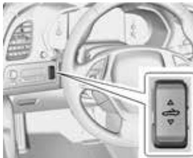
5. Drücken Sie lange auf den unteren Teil von
