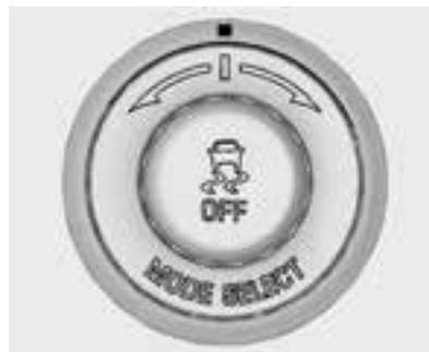
Zur Auswahl dieses optionalen Fahr-dynamikmodus muss der Rennmodus aktiviert sein. Drücken Sie dann zweimal schnell auf die TCS/StabiliTrak-Taste
