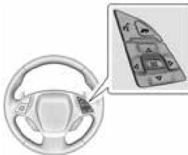
Mit den rechten Lenkradtasten können Sie die verschiedenen Menüpunkte und Displays öffnen und durchsehen.
