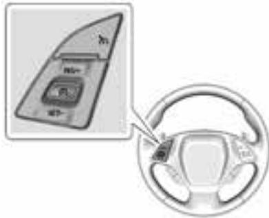
**Ein/Aus**: Drücken, um den Geschwindigkeitsregler ein- und auszuschalten. Wenn der Geschwindigkeitsregler eingeschaltet wird, leuchtet eine weiße Anzeigeleuchte im Instrument auf.
