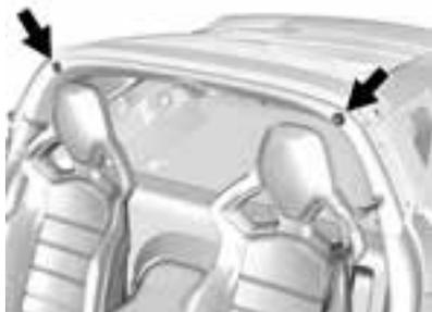
5. Platzieren Sie die Hinterkante des Daches neben dem Dichtungsprofil hinten an der Dachöffnung. Dann die Raststifte am hinteren Ende des Daches auf die Öffnungen an der hinteren Dichtung ausrichten und einsetzen. Die Vorderseite des Daches vorsichtig vorne auf die Dachöffnung absenken.
