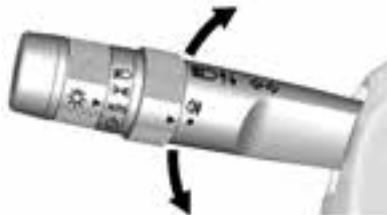
Um einen Richtungswechsel zu signalisieren, führen Sie den Hebel ganz nach oben bzw. unten.
