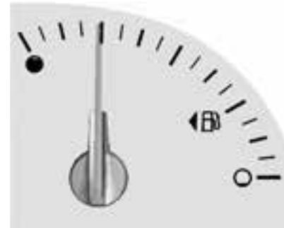
Die Kraftstoffanzeige zeigt bei eingeschalteter Zündung den ungefähren Kraftstoffstand im Tank.
