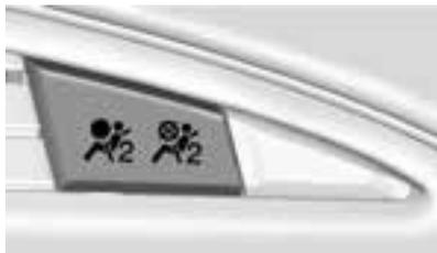
Unter bestimmten Bedingungen schaltet das System zur Beifahrer-Sitzbelegungserkennung den Beifahrer-Front-Airbag aus. Das System zur Beifahrer-Sitzbelegungserkennung hat keinen Einfluss auf andere Airbags. Siehe *Sitzbelegungssystem auf Seite 3-23*.
