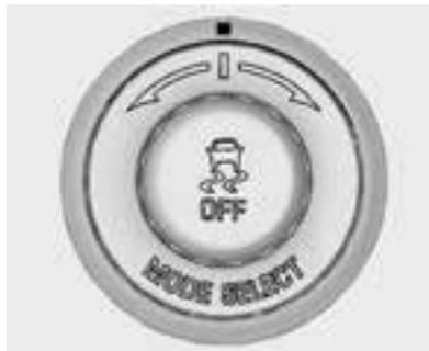
Die TCS/StabiliTrak-Taste befindet sich in der Mittelkonsole.
