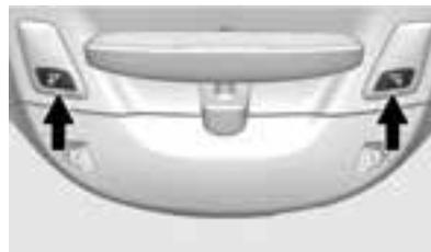
Die Leseleuchten befinden sich in der Dachkonsole. Die Leuchten werden eingeschaltet, wenn eine Tür geöffnet wird. Drücken Sie bei
