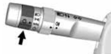
Der Regler für die äußeren Leuchten befindet sich am Blinkerhebel.
