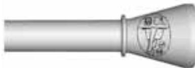
1. Machen Sie im Fahrzeuginnenraum den Trichteraufsatz für das deckellose System ausfindig.
