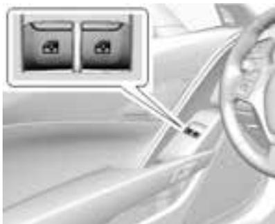
Drücken Sie den Schalter bis zum ersten Einrastpunkt, um das Fenster zu öffnen. Ziehen Sie den Schalter bis zum ersten Einrastpunkt, um das Fenster zu schließen. Lassen Sie den Schalter los, wenn das Fenster die gewünschte Position erreicht hat.
