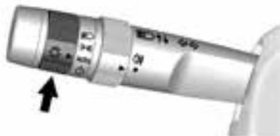
Die Einstellung der Außenbeleuchtung erfolgt über den Blinkerhebel.
