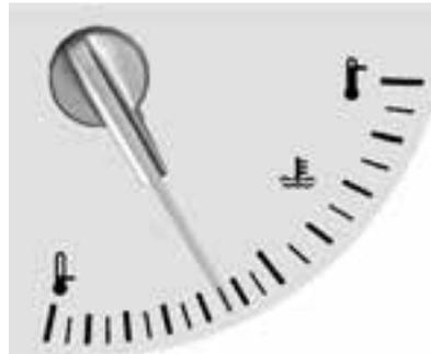
Diese Anzeige zeigt die Kühlmitteltemperatur des Motors an.
