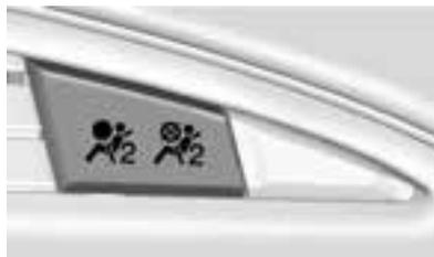
Beim Starten des Fahrzeugs leuchten in der Beifahrer-Airbag-Statusanzeige die Symbole für EIN und AUS einige Sekunden im Zuge der Systemüberprüfung auf. Nach einigen weiteren Sekunden leuchtet in der Statusanzeige entweder das
