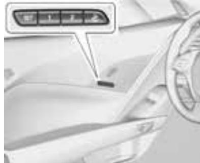
Sofern vorhanden, werden mit den Tasten „1“, „2“, SET und
