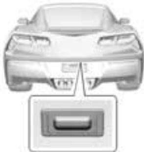
Drücken Sie zum Öffnen des Kofferraums auf das Entriegelungstastfeld, während sich der RKE-Transmitter in einer Entfernung von höchstens 1 m (3 ft) befindet.
