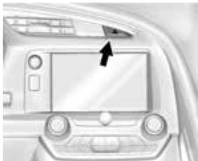
Der Warnblinker zeigt an, dass Sie in Schwierigkeiten sind. Der Schalter befindet sich im mittleren Bereich der Instrumententafel.
