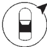
Das Fahrzeugsymbol kennzeichnet die aktuelle Position und den Kurs des Fahrzeugs auf der Karte. Bei aktiver Routenführung wird ein Kreis mit einem Pfeil zum Fahrzeugsymbol hinzugefügt, der die Richtung des Ziels anzeigt.
