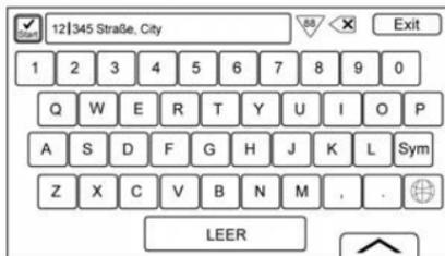
Die Tastatur kommt für verschiedene Zwecke und zahlreiche Funktionen im ganzen System zum Einsatz. Das Navigationssystem wird über die alphanumerische Tastatur bedient, die folgende Tasten enthält: 1 bis 0, A bis Z im QWERTY-Layout, Bindestrich, Komma, Punkt, SPACE (LEERZEICHEN) und Sym (zur Eingabe weiterer Zeichen).
