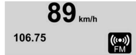
**Ansicht Audio/Mobiltelefon** : Hier wird die Geschwindigkeitsansicht zusammen mit Informationen zu Audio/Mobiltelefon angezeigt. Es können der momentan eingestellte Radiosender, der Medientyp und eingehende Anrufe angezeigt werden.
