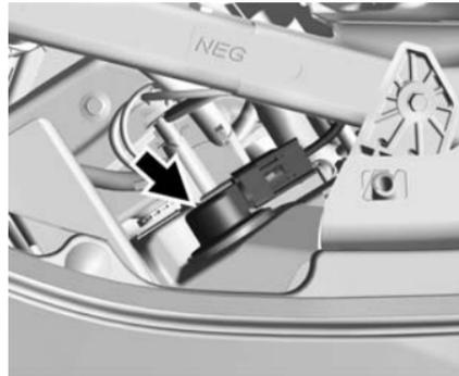
3. Die Fassung linksherum aus dem Scheinwerferzusammenbau herausdrehen.
