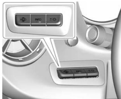
Das Bedienelement für das Head-up-Display befindet sich links neben dem Lenkrad.
