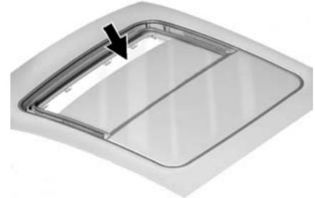
Schmutz und Ablagerungen können sich an der Schiebedachdichtung oder Laufschiene ansammeln. Dies kann zu Geräuschen oder Problemen beim Schiebedachbetrieb führen. Außerdem kann das Wasserableitsystem verstopft werden. Öffnen Sie regelmäßig das Schiebedach, und beseitigen Sie eventuelle Hindernisse und Verschmutzungen. Reinigen Sie die Schiebedachdichtung und den Dichtbereich des Dachs mit einem sauberen Tuch und schwacher Seifenlauge. Entfernen Sie kein Fett vom Schiebedach.
