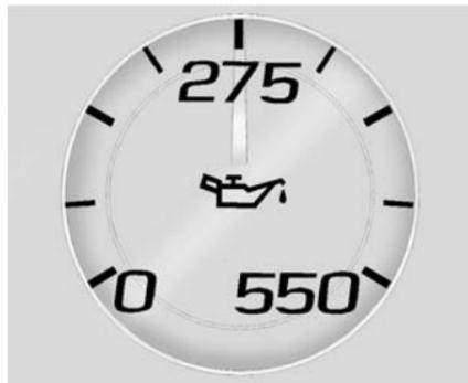
Die Motoröldruckanzeige zeigt bei laufendem Motor den Motoröldruck in kPa (Kilopascal) an.
