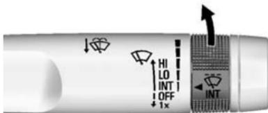
**INT** : Für Wischintervalle bringen Sie den Hebel in die Position INT und drehen Sie dann den Ring
