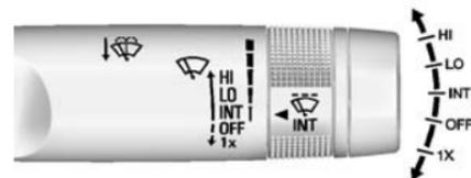
Der Hebel der Wisch-/Waschanlage befindet sich an der rechten Seite der Lenksäule. Bei Zündung auf ON bzw. ACC/ACCESSORY mit dem Wischerhebel die Wischergeschwindigkeit auswählen.
