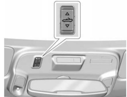
5. Drücken Sie lange auf den unteren Teil von
