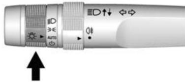
Der Schalter für die Außenbeleuchtung befindet sich an der Instrumententafel auf der Außenseite neben dem Lenkrad.
