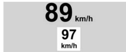
**Ansicht Geschwindigkeit** : Diese Anzeige enthält den Tachometerwert, die Getriebeposition (nur bei Automatikgetriebe) und die Geschwindigkeitswarnung.
