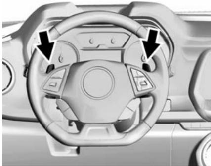
Mit Tap Shift kann das Automatikgetriebe manuell gesteuert werden. Tap Shift kann nur im DSC-Modus verwendet werden. Fahrzeuge mit dieser Funktion haben entsprechende Hinweise am Lenkrad. Die Schaltwippen befinden sich an der Rückseite des Lenkrads. Zum Herunterschalten die linke Schaltwippe (-) drücken, zum Hochschalten die rechte Schaltwippe (+). Der aktuelle Gang wird im Driver Information Center angezeigt.
