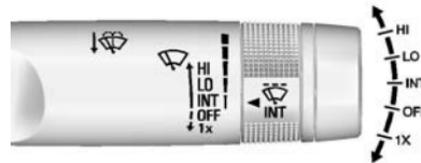
Der Hebel für die Scheibenwischer und die Waschanlage befindet sich auf der rechten Seite der Lenksäule. Bei Zündung auf ON bzw. ACC/ACCESSORY mit dem Scheibenwischerhebel die Wischergeschwindigkeit auswählen.
