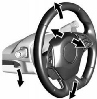
Höhenverstellbares Lenkrad und Teleskoplenksäule einstellen:
