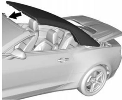
2. Verdeck anheben und von beiden Seiten am Bügel nach vorne in die vollständig geschlossene Stellung ziehen.
