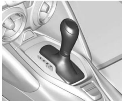
DSC ermöglicht das manuelle Schalten eines Automatikgetriebes. Verwendung der Funktion DSC:
