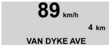
**Ansicht Navigation** : Hier wird die Geschwindigkeit zusammen mit Informationen der Turn-by-Turn-Navigation angezeigt. Wenn keine Routenführung aktiv ist, wird der Kompasskurs angezeigt.
