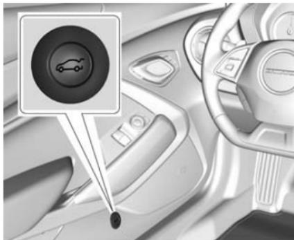
Aus dem Fahrzeuginneren drücken Sie hierzu die Taste
