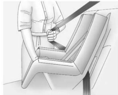
4. Ziehen Sie den Schultergurt ganz aus dem Gurtaufroller heraus, um die Blockierung einzustellen. Wenn die Blockierung des Gurtaufrollers eingestellt ist, kann der Gurt gestrafft werden aber nicht aus dem Gurtaufroller gezogen werden.
