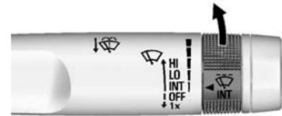
**INT** : Für Wischintervalle bringen Sie den Hebel in die Position INT und drehen Sie dann den Ring INT nach oben für häufigeres Wischen bzw. nach unten für weniger häufiges Wischen.
