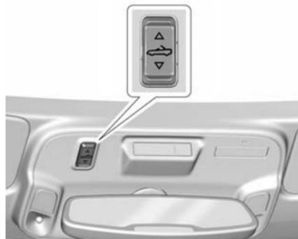
6. Drücken Sie lange auf den oberen Teil von
