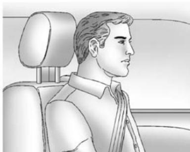
Stellen Sie die Kopfstütze so ein, dass sich deren Oberkante auf gleicher Höhe mit der Oberseite des Kopfes des Insassen befindet. In dieser Position wird die Wahrscheinlichkeit einer Nackenverletzung bei einem Unfall verringert.
